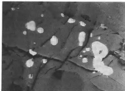
Скопления каплевидного ильменита в оливине. Оливинитовый пироксенит из архейского комплекса в Прибайкалье. Полированный шлиф. Увел. 60.
