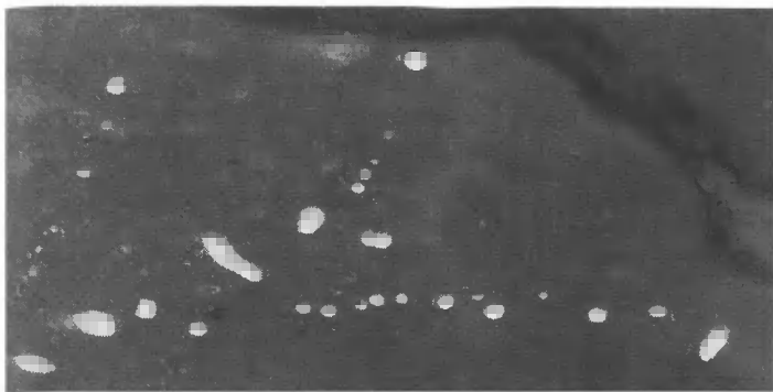
Каплевидные выделения сульфидов в шпинелиевом перцолите из трубки взрыва Северо-Минусинской впадины. Полированный шлиф. Увел. 600.
